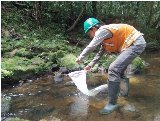
Gambar 56 dan 57. Pengambilan Sampel Air di Sungai Tumok Rona RKT 2024 dan Hasil Uji Sampel Air
